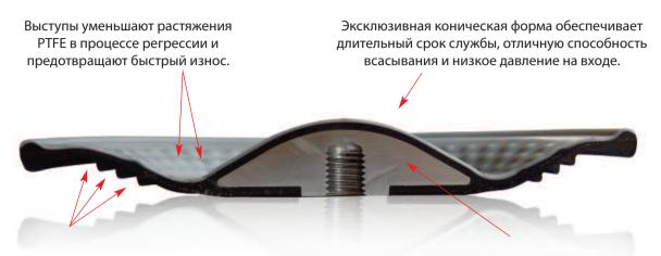
Вспомогательные рёбра обеспечивают и регулируют гибкость диафрагмы для увеличения срока службы и снижения кавитации на входе.
