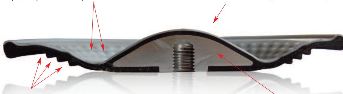
Вспомогательные рёбра обеспечивают и регулируют гибкость диафрагмы для увеличения срока службы и снижения кавитации на входе.
